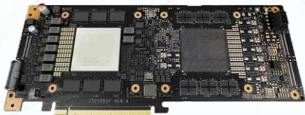
Atlas 200I SoC A1是面向边缘推理服务器市场的核心板，提供“基础通用算力+超强AI算力”。该核心板为全高全长（10.5英寸）PCIe 标卡形态，可以适配1U/2U机箱，支持客户开发自有品牌的整机，可广泛应用于OCR识别、目标识别、搜索推荐、内容审核等诸多AI应用场景。
